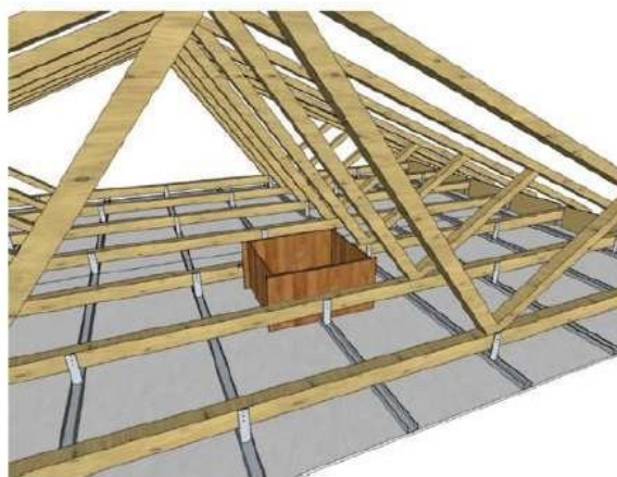
Figure 6 : Traitement des trappes d'accès
